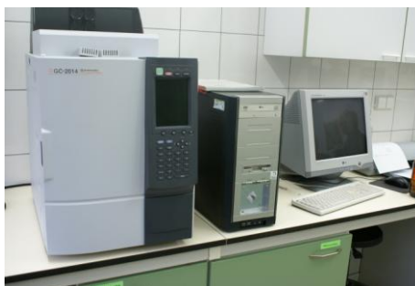
Fot.4. Nowoczesny skomputeryzowany zestaw do chromatografii gazowej
