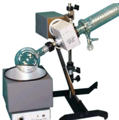
Fot. 2. Wyparka obrotowa
